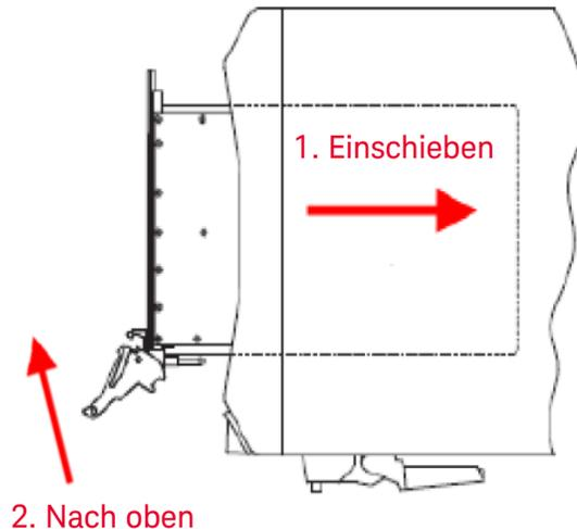
7. Schieben Sie das Modul vorsichtig ganz in das Gehäuse. Sobald Sie einen Widerstand spüren, ziehen Sie den Verriegelungsgriff nach oben, um das Modul vollständig einzusetzen und im Gehäuse zu verriegeln. Siehe hierzu obige Abbildung.
